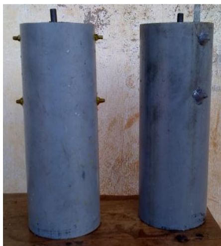
Deux cellules tubulaires en PVC
