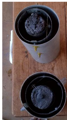
Montage des électrodes à l'intérieur des tubes
