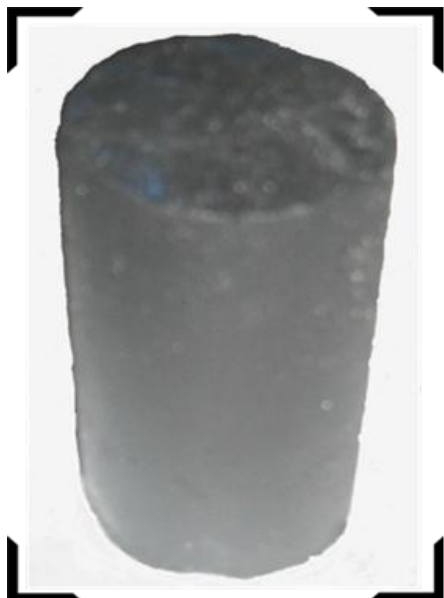
Figure 9 : la figure montre l'éprouvette de compression.
