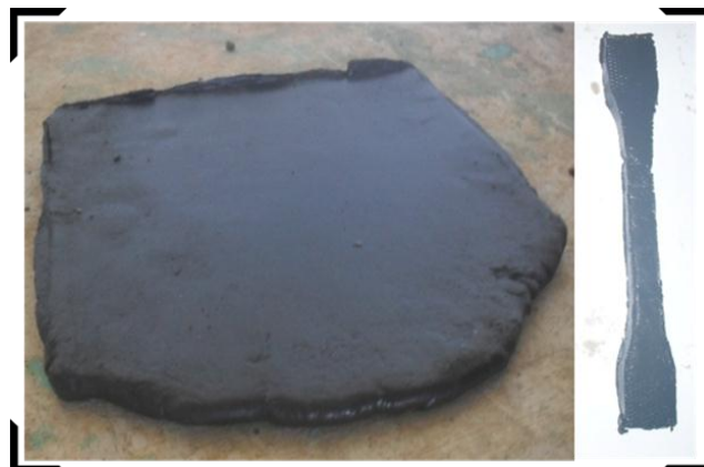
Figure 5 : la figure montre l'éprouvette de traction prélevée à partir d'une plaque.
