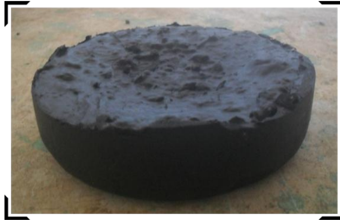
Figure 7 : la figure montre l'état solidifié du liant composé de 70% DREC et 30% Sachet plastique.
