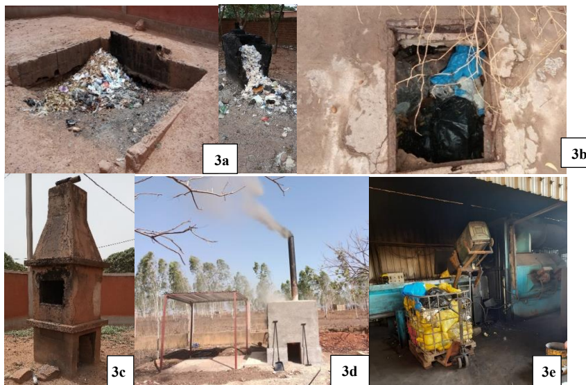
Photo 3 : Illustration de cas d'élimination des déchets par brûlage à l'air libre (3a), enfouissement (3b), par incinération avec une technologie d'une chambre à combustion (3c et 3d) et avec une technologie de 02 chambres à combustion (3e).
